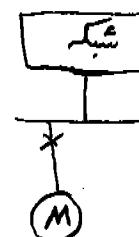
(عمل نکردن رله هادر صورت بروز)  $\rightarrow$  (تنظیم رله حابرمبنای)  $\rightarrow$  (جریان غالب)  $\rightarrow$  (عدم عمل کردن  $X_N$ )
